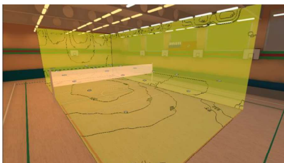
Рис. 2. Расположение расчетных плоскостей для закрытых спортивных объектов
