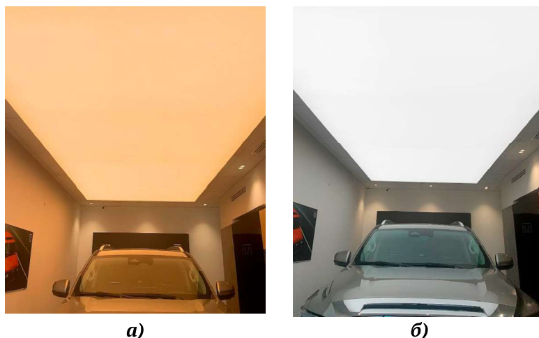
Рис. 3. Фотографии различного визуального восприятия цвета автомобиля (серебро): КТЦ светового потолка 2700 К (а), КТЦ светового потолка 6000 К (б)
