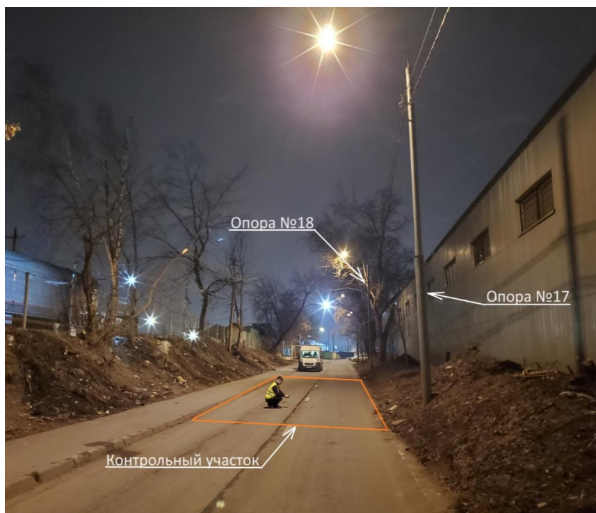
Рис. 3. Проведение измерений стационарным методом
