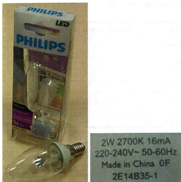
Рис. 51. Пример образца из партии ламп, отобранного для проведения испытаний аккредитованной лабораторией
